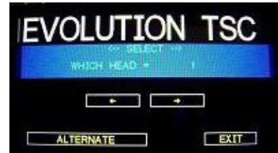
Al seleccionar ALTERNO, en este caso, se invoca un conjunto alternativo de submenús que tratan directamente con el sistema de desplazamiento. De nuevo, el tipo de dispositivo auxiliar puede variar y actualmente está limitado al Sistema de desplazamiento o al Dispensador de etiquetas.
