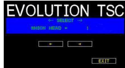
Nota: Si varios cabezales de impresión tienen la misma "DIRECCIÓN DE LA UNIDAD", se producirán resultados indeterminados y también puede devolver un mensaje de "NO RESPUESTA". Nota: Antes de conectarse a una red, debe realizarse cada unidad con una dirección única...
