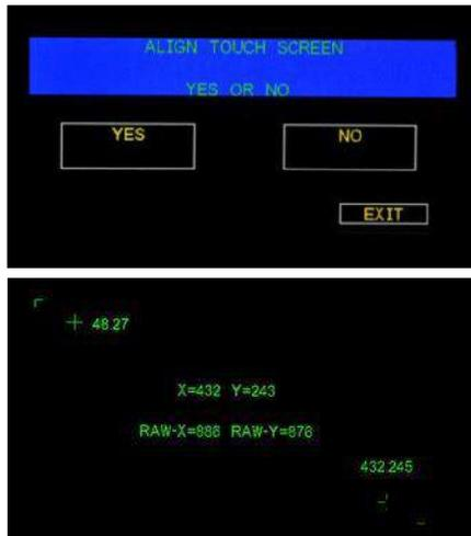
El último paso en la secuencia de reinicio es la pantalla de verificación de alineación de la pantalla táctil. Seleccionando la tecla SÍ se muestra la pantalla de alineación.
