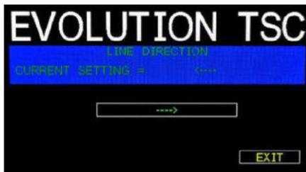
La flecha que se muestra en la tercera pantalla de la pantalla LCD debe coincidir con la dirección de desplazamiento del producto. Presione **◀** Para cambiar la dirección de impresión. Presione SALIR para que la unidad acepte el cambio.
