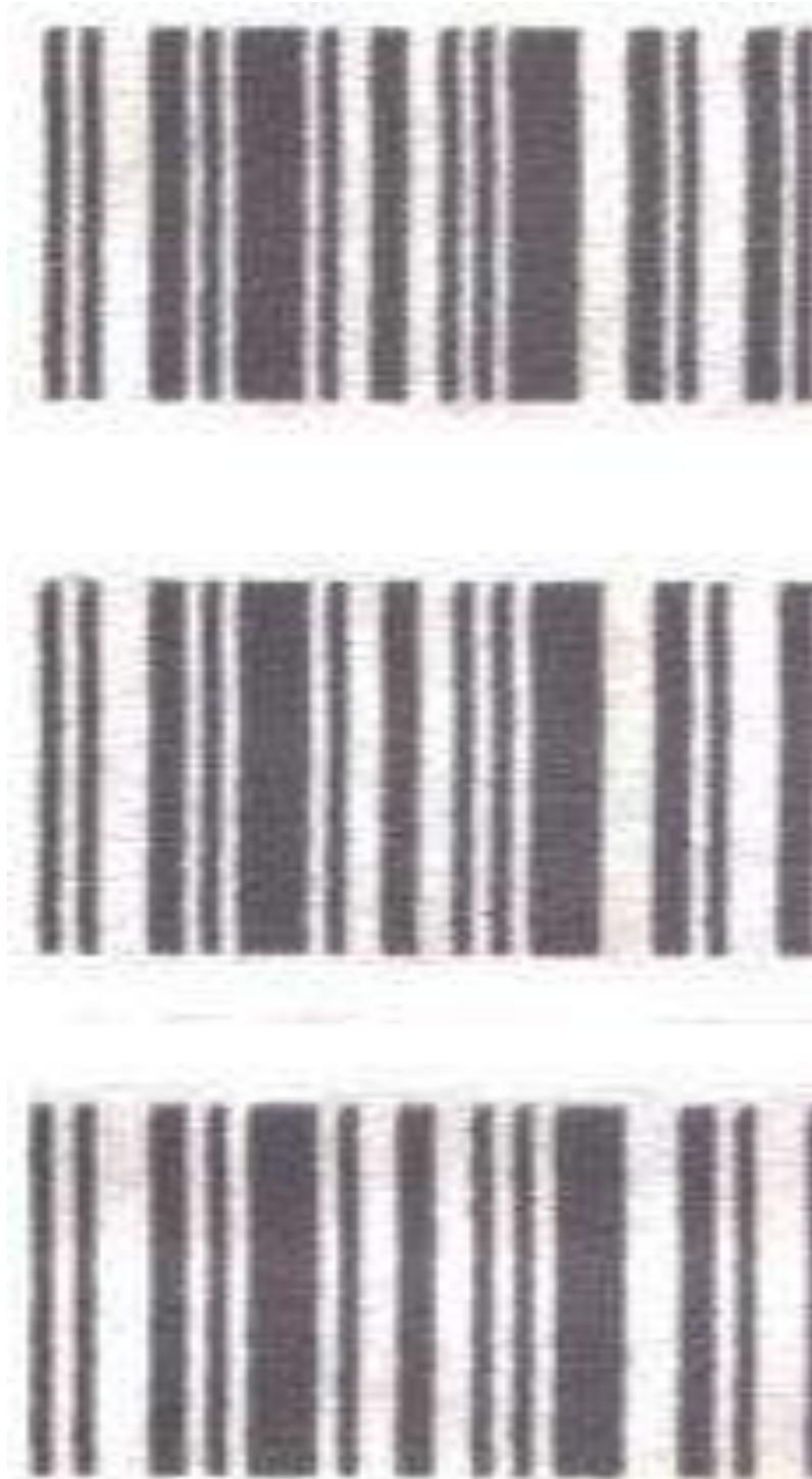
La imagen de abajo es una imagen escaneada de dos impresiones de muestra. La sección superior del código se produce a 60 pies / min que coincide con la velocidad de la línea, mientras que con la segunda muestra, la velocidad de la línea se incrementó a 100 pies / min. Debe ser inmediatamente evidente en la diferencia en la densidad óptica entre ambas impresiones. Esta variación será más aparente en el corrugado marrón que en un sustrato blanco.
