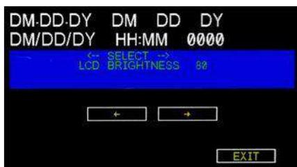
Esta pantalla también proporciona control de la luz de fondo de la pantalla LCD. Seleccione la tecla **MOSTRAR** y use las teclas para controlar la intensidad de la luz de fondo. Seleccione **SALIR** cuando haya terminado. Esta configuración debe establecerse en 25 para un ahorro de energía óptimo.
