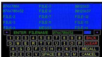
El mismo procedimiento se utiliza para recuperar o guardar un mensaje. La única diferencia es que el nombre de la tecla RECUPERAR se cambiará a ALMACENAR. Primero se determina si la operación es cargar un mensaje nuevo o almacenar el mensaje actual.
