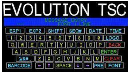
El usuario tiene dos opciones para editar o cambiar un mensaje. Si se va a ingresar un nuevo mensaje, presione la tecla BORRAR para eliminar todo el mensaje existente.
