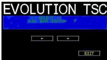
El parámetro predeterminado del sistema establece que el tamaño normal de una barra estrecha es igual a 5 columnas verticales. Este valor, que es variable de 3 a 15, se puede seleccionar dependiendo de la longitud total del código de barras que se va a imprimir. Este valor establece tanto el ancho nominal de las barras claras como las oscuras.
