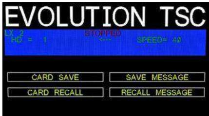
Hay dos métodos para guardar o recuperar mensajes. El primer método es similar al controlador de mano actual, donde el usuario puede desplazarse por los mensajes disponibles para seleccionar la ubicación de almacenamiento deseada usando las teclas ◀ ▶.
