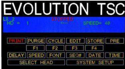
El controlador TSC puede almacenar hasta 200 mensajes programados en todo el sistema y sus parámetros asociados. Siga estos pasos para ingresar ALMACENAMIENTO DE MENSAJES. Después de crear el mensaje, presione ALMACENAR en la PANTALLA PRINCIPAL.
