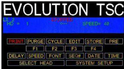
Se puede instalar un cartucho de tinta simplemente reemplazando el cartucho. El nivel de tinta actual se puede ver seleccionando la tecla F4 en el menú DETENIDO.
