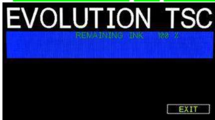
Cabe señalar que, dependiendo de la impresora específica conectada actualmente, el menú Nivel de tinta diferirá. Cuando un cabezal de impresión LEXMARK es el cabezal de impresión seleccionado actualmente, se verá la foto de la izquierda. En este caso, el sistema informa que quedan 100% de TINTA. Si es un HP o SC
