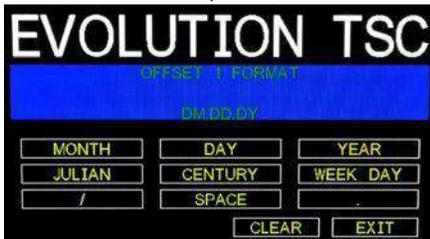
El valor predeterminado que se envía de fábrica es dm / dd / dy, y se puede modificar según sea necesario. Si se seleccionó el formato de desplazamiento, la palabra FECHA se reemplaza con la palabra DESPLAZAR.
