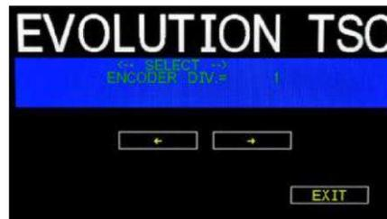
Cambie el ancho de impresión presionando la tecla VELOCIDAD. Ajuste el ancho de impresión deseado en relación con la velocidad real de la línea, si se conoce. Ajuste el ancho del carácter deseado utilizando las teclas. Presione la tecla SALIR para regresar al menú anterior. Tenga en cuenta que cuando se selecciona el modo de codificador externo, LINE SPEED = 40 cambia a ENCODER DIV = 1 para indicar que el sistema está en modo de codificador externo.
