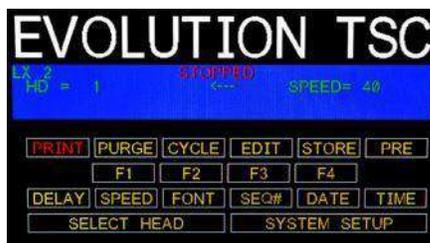
La primera vez que se enciende la estación de impresión, tal como se recibió de fábrica, la pantalla LCD se verá como la foto de la izquierda. Cada sección de la pantalla LCD proporciona información importante sobre el sistema:
