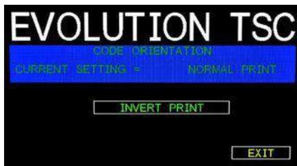
Este parámetro permite que el código se imprima hacia arriba o hacia abajo. Presione INVERT PRINT para los códigos al revés. Guarde la elección presionando SALIR. Busque el cambio de dirección en la impresión.
