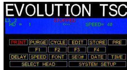
El modo STOPPED se utiliza para cambiar las funciones de la impresora. Cuando se encuentre en el Modo detenido, la pantalla mostrará PARADA en la línea superior y la pantalla se verá como la ilustración de la derecha. Cuando se DETIENE, la impresora no imprimirá cuando el producto pase el conjunto del cabezal de impresión.
