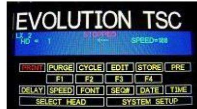
La pantalla SELECCIONAR CABEZA permite al usuario seleccionar varios cabezales de impresión en un entorno de múltiples cabezas o un dispositivo ALTERNO (auxiliar).
