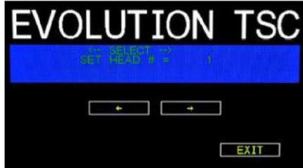
Cada cabezal de impresión puede contener una dirección única para distinguir varios cabezales de impresión cuando se controla mediante un solo controlador de mano o un enlace de datos de computadora utilizando un enlace de datos RS485. El valor predeterminado para cada nuevo módulo de cabezal de impresión es DIRECCIÓN
