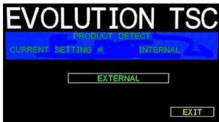
Esta selección de menú permite al usuario seleccionar la fuente de la función de detección del producto. El valor predeterminado del sistema es INTERNO. Presione EXTERNO para usar un sensor de detección de producto externo. Si es necesario detectar una parte del producto que no está directamente delante del cabezal de
