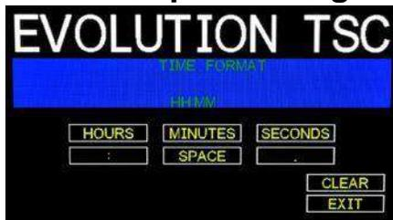
El valor predeterminado de fábrica para el formato de hora es hh: mm y se puede cambiar según sea necesario. Presione la tecla BORRAR y se borrará la última línea de la pantalla.
