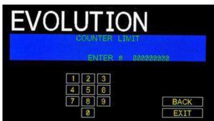
Seleccionando **YES** permite al usuario ingresar el el máximo deseado (mínimo para la cuenta regresiva) Los dígitos se introducen a través del teclado derecho justificado. Como ejemplo para establecer una cuenta máxima de 5000 entrar en 5000.
