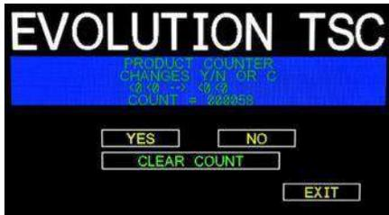
Los datos recién ingresados se vuelven a mostrar para su verificación o corrección, si es necesario. Presione la tecla **SÍ** para cambiar los datos o la tecla **NO** para finalizar y volver al menú anterior
