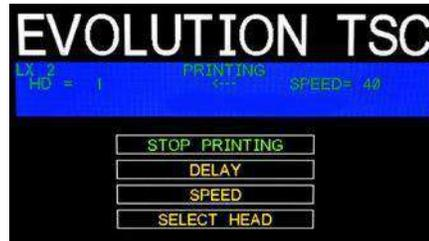
Para configurar la velocidad de línea (ancho de caracteres), presione la tecla VELOCIDAD en los menús DETENIDO o IMPRIMIENDO.
